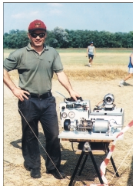
Giuseppe Franco, al banco prova, con una turbina di realizzazione personale dalla spinta dichiarata di 9 Kg (ispiratasi alla KJ 66)
