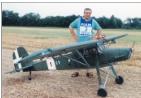
Adriano Cristiani con un grosso Fiesler Storch in versione recupero feriti. Apertura alare metri 3,60, peso 14 kg. Motore ST 45 cc.
